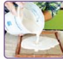
Gambar Foto 2.1.13 Contoh tuangan sejuk menggunakan plaster of paris
