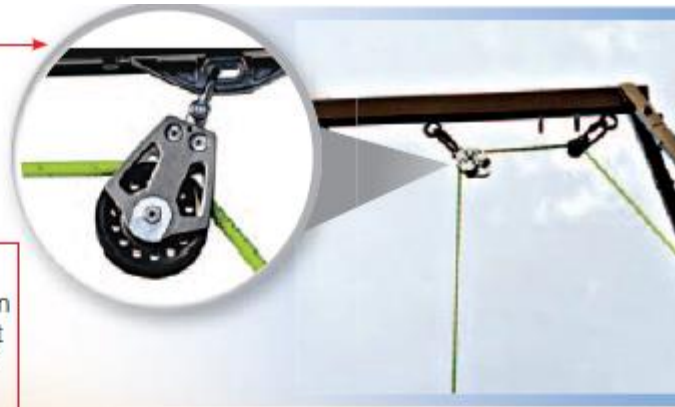
Gambar Foto 2.2.4 Penggunaan takal memudahkan kerja-kerja mengangkat beban yang berat
