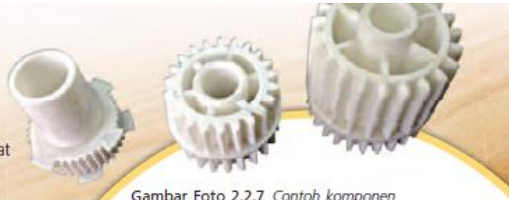
Gambar Foto 2.2.7 Contoh komponen yang diperbuat daripada plastik yang dihasilkan daripada kaedah tuangan/ suntikan (injection)
